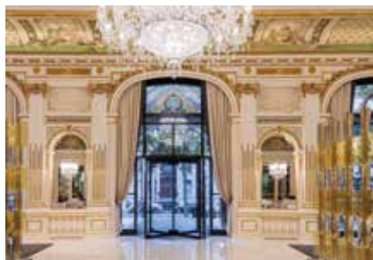
Een draaideur is een relatief efficiënte manier om de energetische prestaties van de inkom te verbeteren zonder ingrijpende bouwkundige aanpassingen. (The Peninsula Hotel Paris)
